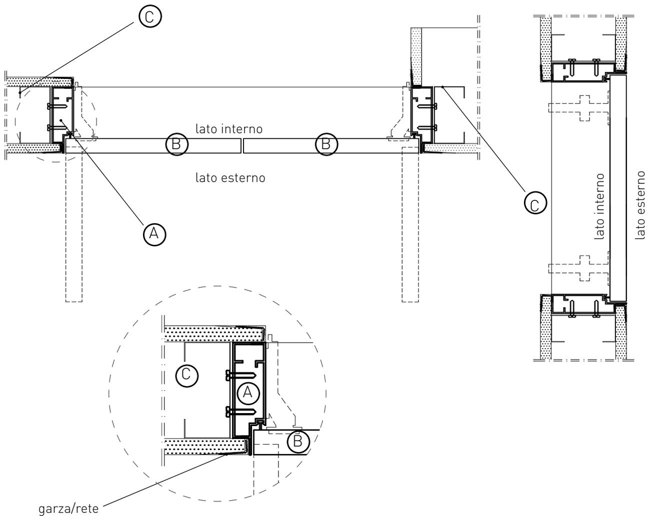
· Inserire nel vano lo sportello completo delle ante "B" già montate sul telaio "A", avendo cura di rispettare il piano e il piombo in ogni direzione.
